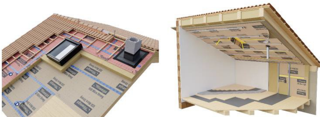
Figura 7 Esempi di stratigrafie con schermi al vapore (freni o barriere al vapore situati sul lato interno del pacchetto isolante) e membrane traspiranti (situato sul lato esterno del pacchetto isolante). Fonte: Riwege.
